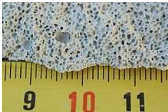
Figura 12. Ingrandimento della struttura del Gasbeton
